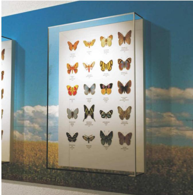
Die gesamte Verglasung besteht aus Floatglas. Sämtliche Glasteile haben eine Dicke von einheitlich 8 mm. Blickschatten oder ähnliche Probleme sind nahezu ausgeschlossen, da sämtliche Kanten geschliffen und poliert sind. Diese Vitrine wird vorzugsweise als Flachvitrine für Urkunden, Dokumente oder Gemälde eingesetzt.
